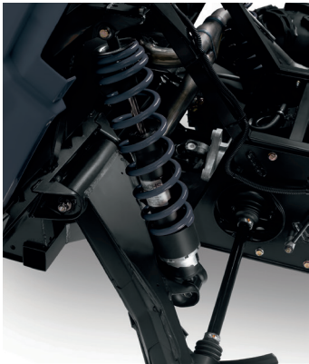
SUSPENSION ARRIERE INDEPENDANTE AVEC BRAS D'ARTICULATION A TORSION (TTI)
