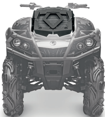
RADIATEUR ET PRISE D'AIR DÉPLACÉS
